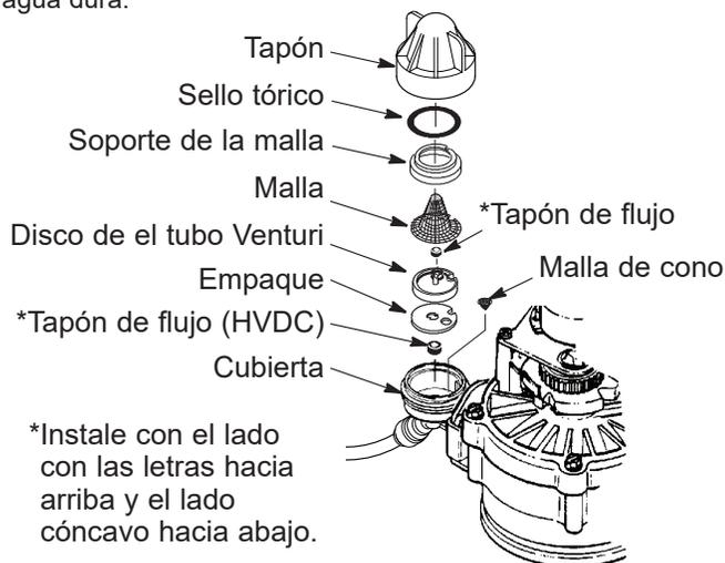
**IMPORTANTE:** Asegúrese de que el orificio pequeño del empaque se centre directamente sobre el orificio pequeño de la cubierta de la boquilla y del tubo Venturi. Asegúrese de que los números estén mirando hacia arriba.
